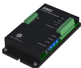
Блоки управления BMD предназначены для управления работой коллекторных двигателей постоянного тока с напряжением питания до 24В. Блок BMD управляет скоростью, направлением и активным торможением мотор-редукторов постоянного тока с номинальным током до 12А.
