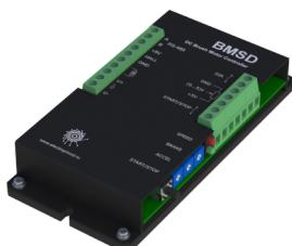
Контроллер BMSD предназначен для управления коллекторными двигателями постоянного тока с энкодером на основе датчика Холла или без обратной связи. Блок работает в автономном режиме, либо управление по интерфейсу RS-485. Связь блока с ПК осуществляется по интерфейсу RS-485. Блок управляет скоростью и направлением вращения мотор-редуктора постоянного тока с номинальным током до 12А.
