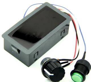
Регулятор CCM5D позволяет управлять скоростью вращения коллекторного двигателя постоянного тока до 5А с помощью широтно-модулированных PWM. Напряжение постоянного тока полностью регулируется от 0%-100%. Регулятор скорости может обеспечить непрерывный ток 8А для двигателя постоянного тока.
