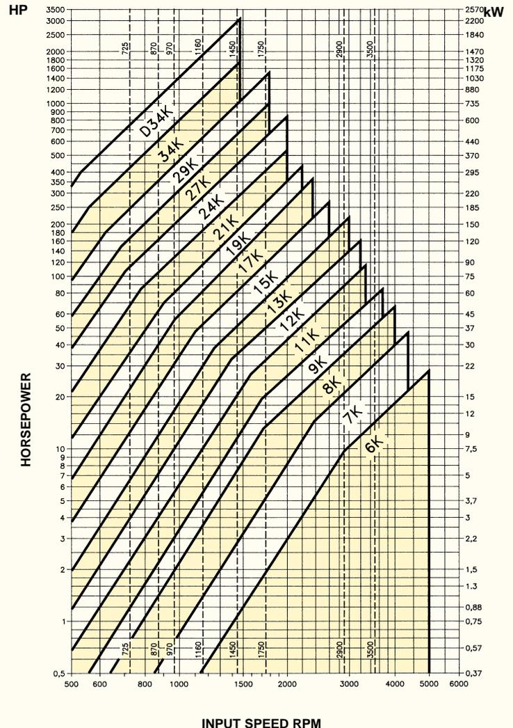
THE CURVES SHOW LIMIT CAPACITY OF COUPLING
